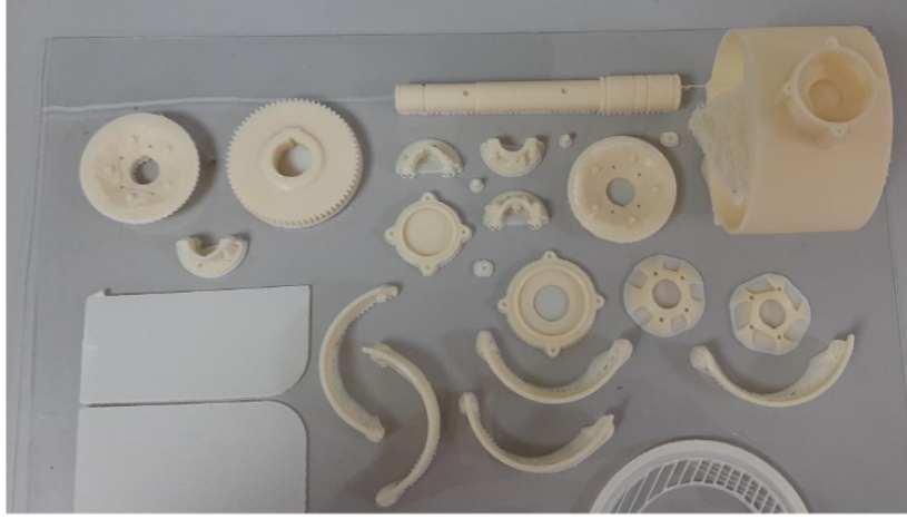
Şekil 9. 3D Printerde yazdırılmış prototip türbin parçaları.
